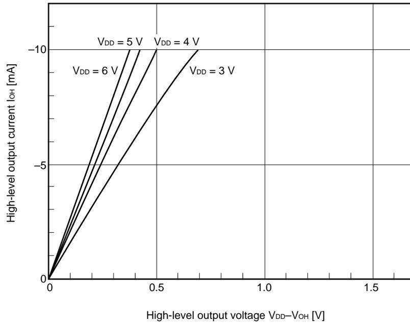
$I_{OH}$  vs.  $V_{DD}-V_{OH}$  (Port 8-Port 12)
